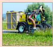
Der Graswuchs entlang von Strassen wird mit speziellen Böschungsmähern geschnitten. Diese Maschinen zeichnen sich durch Kompaktheit und einzigartige Bauweise aus. Das Mähgut wird in einem Arbeitsgang geschnitten, in den aufgesattelten Container gesaugt und transportiert; im Prinzip ein übergrosser Rasenmäher. In den Wachstumsphasen Frühling und Herbst sind diese Maschinen wieder auf den Luzerner Kantonstrassen im Ein-
